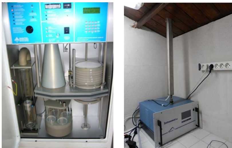
Figure 2-5 : Photos du préleveur DA80, Digital® (gauche) et de l'analyseur MP101M, Environnement, SA (droite)
