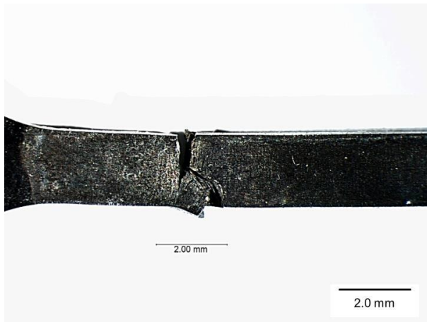
a) Macrographie optique, présence d'un film noir sur la surface.
