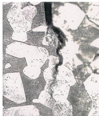
Figure 5 – Micrographie optique de la zone imagée en fond de fissure [1].
