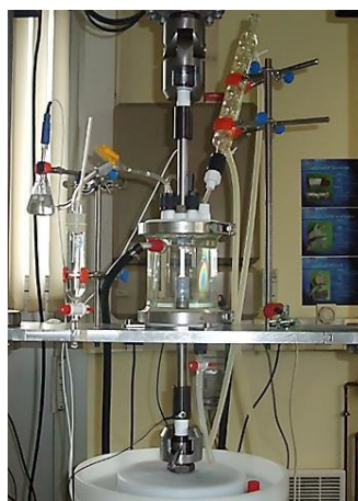
Figure 12 – Photographie du montage expérimental de traction lente.
