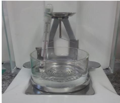
Figure 3.5 : Balance de pesée hydrostatique dans deux fluides
