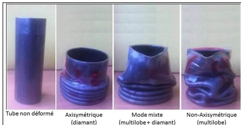
Figure 2.12 : mode de flambement possible pour des structures tubulaires métalliques en compression [41]
