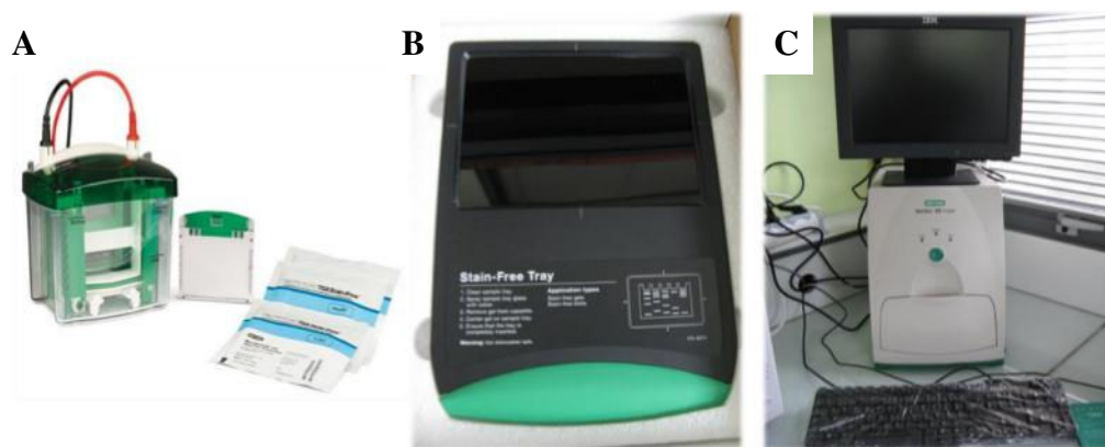
Figure III.A.8 : Présentation du dispositif d'électrophorèse, de la migration des protéines à leur détection. Dispositif d'électrophorèse et gels Stain free Mini-PROTEAN® TGX™ (A) à déposer sur la plaque de révélation (B) et à insérer au sein du scanner Gel Doc™ EZ (Bio-Rad) (C).
