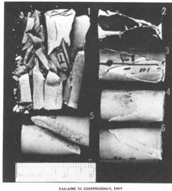
FIGURE 1.2 – Exemples de ruptures fragiles dans différents échantillons soumis à des conditions de pression et de température variables (d’après [Evans et al., 1990]). L’échantillon 1 a subi une déformation à des conditions de pression et de température ambiantes. Les échantillons 2, 3 et 4 ont été déformés à une pression de confinement faible ( <65\text{MPa} ) et à des températures respectives de 400, 150 et 300^\circ\text{C} . Les échantillons 5 et 6 ont été déformés à des pressions de confinement plus importantes ( \sim 75\text{MPa} ).
