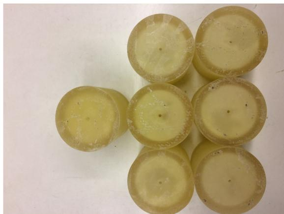
FIGURE 2.8 – Échantillons de résonateurs imprimés avec l'imprimante 3D.
