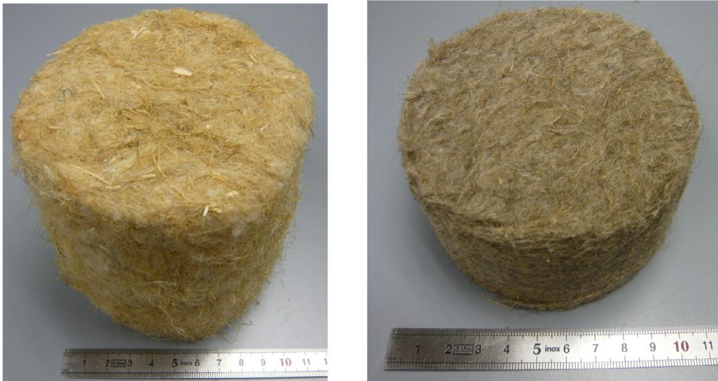
FIGURE 1.13 – Exemple des matériaux poreux de type laine : à gauche, l'échantillon de laine de chanvre; à droite, l'échantillon de laine de lin [PIÉGAY et al., 2018].
