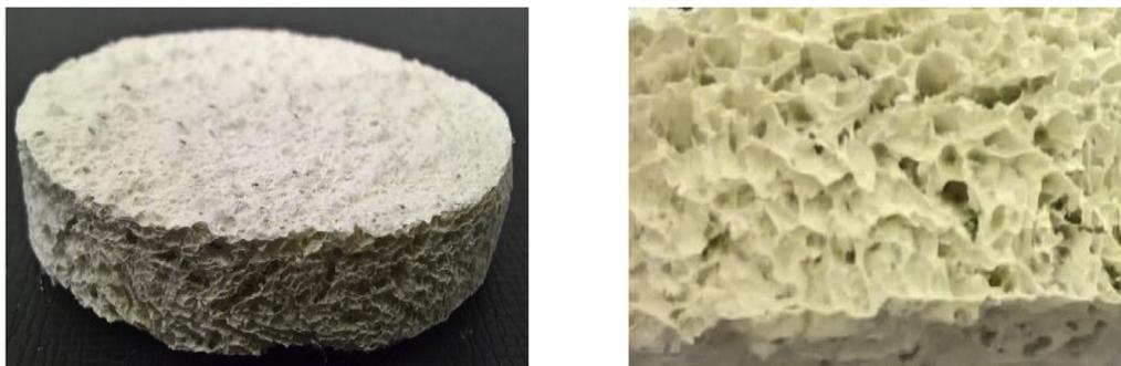
FIGURE 1.12 – Exemple des matériaux poreux de type mousse : à gauche, une vue d'ensemble du matériau; à droite, une vue rapprochée de la structure du matériau [D'AMORE et al., 2017].
