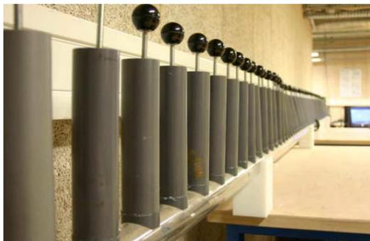
FIGURE 1.53 – Montage de RH en série [RICHOUX et al., 2006].
