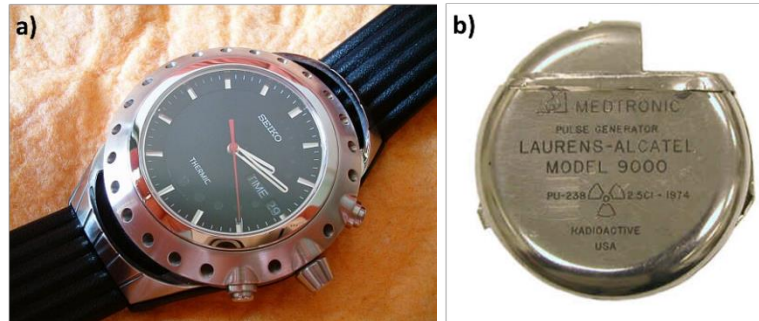
Figure I-11 : (a) La Seiko thermic commercialisée en 1998 est la première montre alimentée uniquement grâce à la chaleur du corps humain. (b) Pacemaker utilisant un RTG au ^{238}\text{Pu} .
