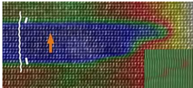
Figure 21: Image d'un hexagone en superposition avec des calculs de GPA avec deux fautes d'empilement opposées I1 et les franges (10\bar{1}0) aux bords de Smalc-Koziorowska et al. [89]
