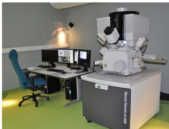
*Figure 13: FIB-SEM FEI 660 NanoLab de Caen*
