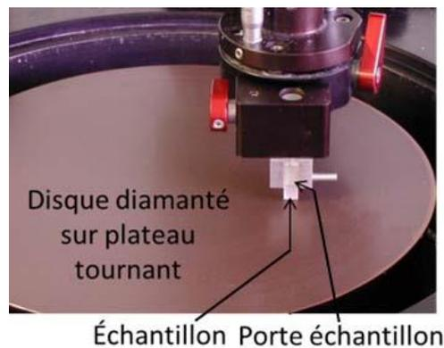
*Figure 11: Polisseuse avec un disque diamanté*
