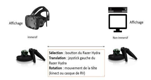
FIGURE 5.12 – Comparer les techniques d'interaction en fonction d'une sitation immersive ou du non-immersive.
