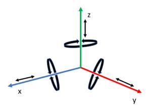
FIGURE 2.3 – Illustration des six DDL.
