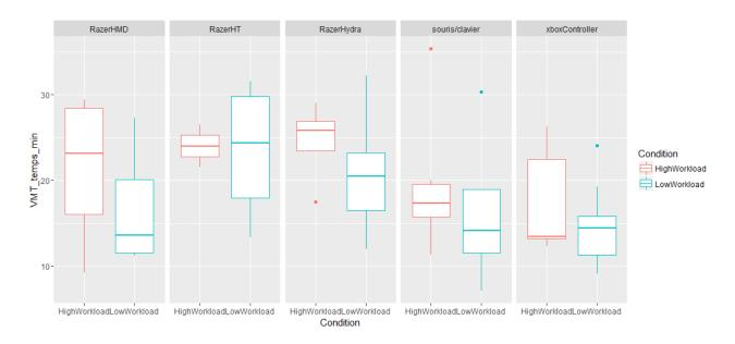
FIGURE 7.12 – Temps de réalisation du VMT en fonction des conditions de charge mentale et des techniques d'interaction.
