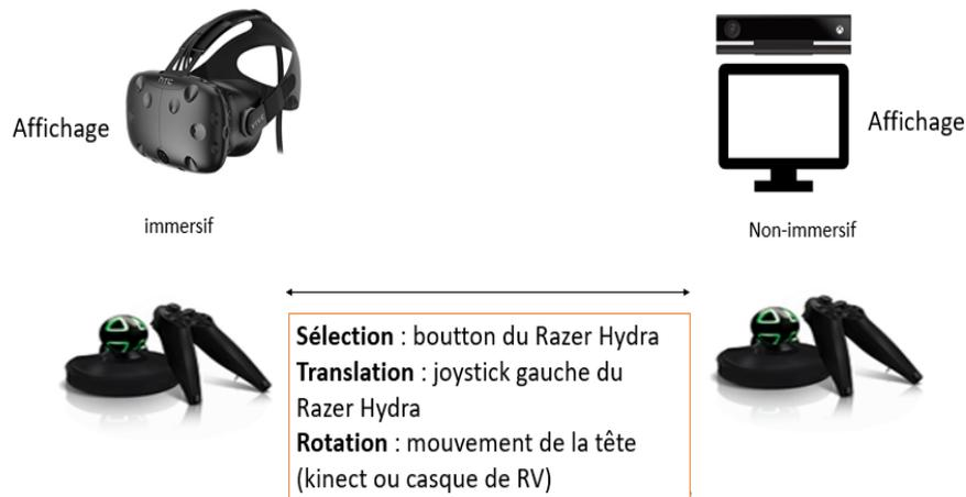
FIGURE 5.12 – Comparer les techniques d’interaction en fonction d’une situation immersive ou du non-immersive.
