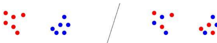
Figure 50 : Ces deux nuages de points correspondent à la visualisation de deux classes indiquées par deux couleurs différentes. L'axe horizontal correspond à un attribut 1 et l'axe vertical à un attribut 2. A gauche, les deux classes sont bien séparées dans l'espace des attributs. A droite les deux classes se recouvrent [91].
