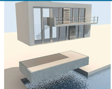
Figure 64 : maison sur un caisson flottant encastré dans la terre ferme. Source : inhabitat.com
