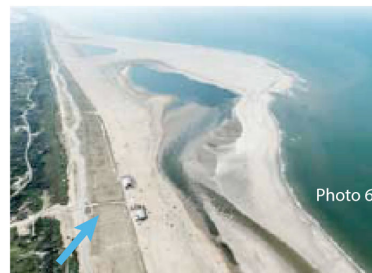
Photos 6a, b et c : évolution observée du banc de sable respectivement en juillet et octobre 2011 et en mars 2012. Source : brochure d'information d'avril 2013, www.dezandmotor.nl
