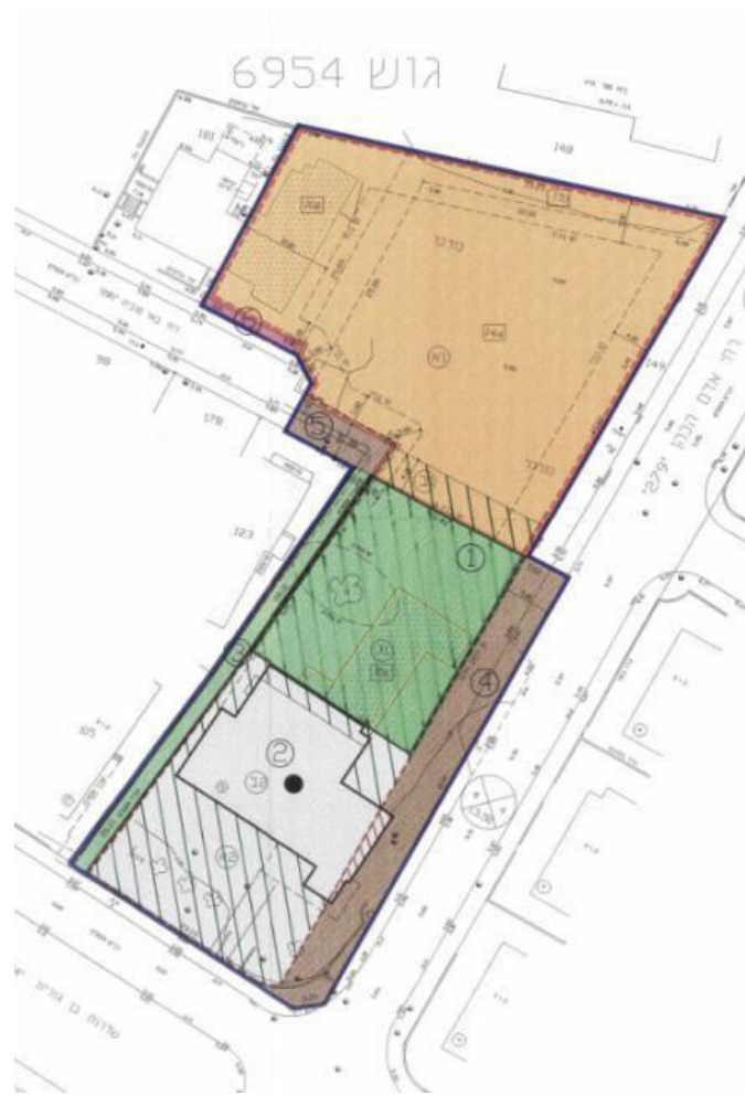
Figure 170: Zones de destination de terrains du plan d'urbanisme: la couleur orange marque la tour résidentielle, le vert – un jardin au milieu en propriété privée mais ouvert au public, le gris est la partie du bâtiment destinée à la conservation, la partie devant être démolie est marquée en jaune dans la surface du jardin ; Source : ADCTJ
