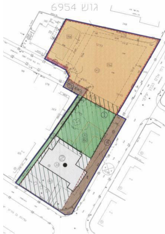
Figure 170: Zones de destination de terrains du plan d'urbanisme: la couleur orange marque la tour résidentielle, le vert – un jardin au milieu en propriété privée mais ouvert au public, le gris est la partie du bâtiment destinée à la conservation, la partie devant être démolie est marquée en jaune dans la surface du jardin ; Source : ADCTJ
