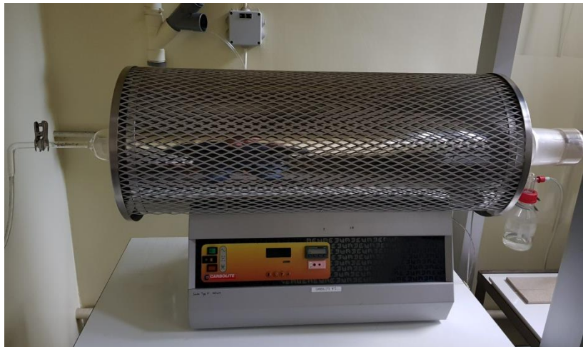
Figure II.3 Four Carbolite utilisé pour les recuits thermiques des échantillons
