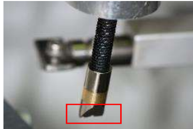
Figure 61 : bec de traction de la machine de traction normalisée a été usiné selon les mêmes critères que le bec de traction de notre banc.
