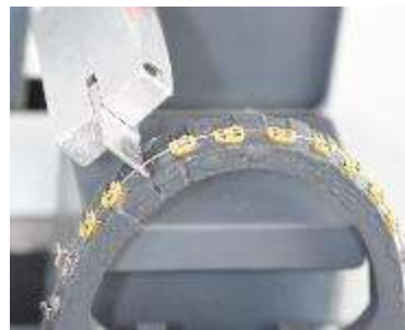
Figure 92 : montage expérimental pour la quantification des forces corono-apicales sur le bracket 5 sur une plaquette courbe.
