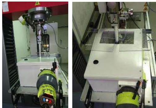
Figure 60 : enceinte thermique et machine de traction normalisée à l'IUT de Moselle-Est (Forbach).
