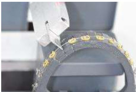
Figure 62 : essai en compression sur la machine de traction normalisée (Forbach) comparé aux essais en traction sur le banc de traction personnalisé pour la quantification des forces verticales ou corono-apicales sur l'attache N°5 positionné sur une plaquette courbe en milieu sec à 35°C.
