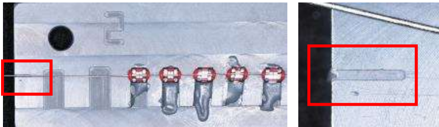
Figure 48 : conception du repère sur les plaquettes planes, la rainure est encadrée en rouge.
