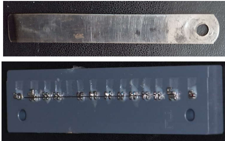
Figure 68 : référentiel de contrôle du collage positionné dans les gorges de tous les brackets collés, permettant de vérifier que les gorges soient toutes alignées entre elles.
