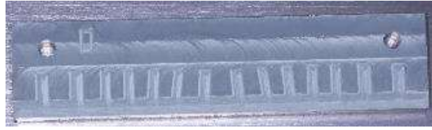
Figure 46 : plaquettes planes pour la mesure des forces mésio-distales.
