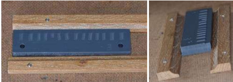
Figure 66 : mise en place des plaquettes planes sur le banc de collage spécifique.
