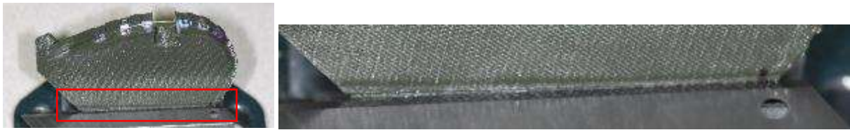
Figure 98 : rainure sur les plaquettes courbes pour optimiser leur positionnement par rapport au bec de traction.
