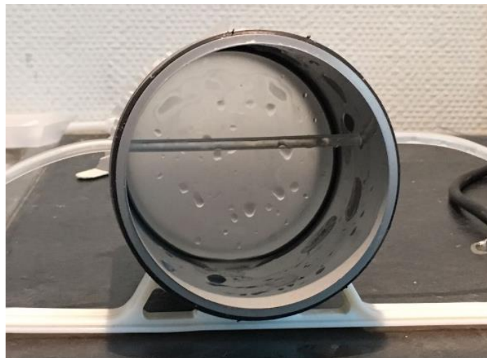
Figure 69 : Support du gel qui est traversé d'un tube permettant de fixer les conditions aux limites.
