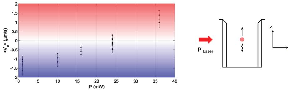
**Figure 0.2** – Vitesse moyenne mesurée en fonction de la puissance laser. Dans cet exemple, il s'agit de particules de Mélamine de rayon  $r = 470\text{ nm}$ . On répète l'expérience à chaque puissance afin de vérifier la reproductibilité des vitesses mesurées à une puissance donnée. On constate que les valeurs moyennes se chevauchent.
