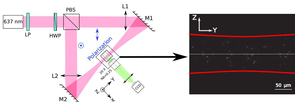
**Figure 0.1** – Montage optique réalisé au cours de la thèse. Le montage est utilisé soit en injectant toute la puissance laser dans un bras, soit en équilibrant la puissance injectée dans les deux bras.
