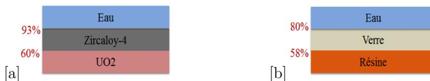
**Figure 2.12** – Coefficients de réflexion d'ondes planes au niveau des différentes interfaces du crayon combustible et de l'échantillon de référence.
