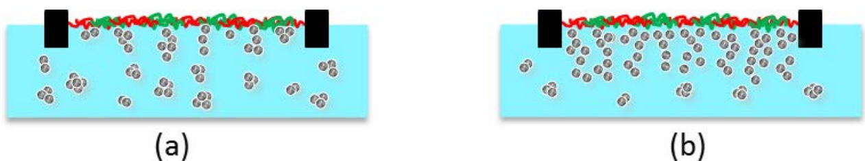
Figure 7.31: Représentation schématique de l'organisation perpendiculaire au plan de l'interface des nanostructures inorganiques formées après la photo-réduction d'ions argent présents dans la sous-phase à pH = 9. (a) Agrégats isolés et (b) agrégats lâches solvatés près de l'interface.
