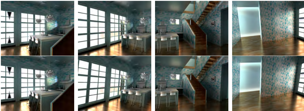
FIGURE 3.7 – Exemple d’images de séquences réalisées sous Blender avec un modèle de caméra à obturateur global (en haut) et un modèle de caméra à obturateur déroulant (en bas).
