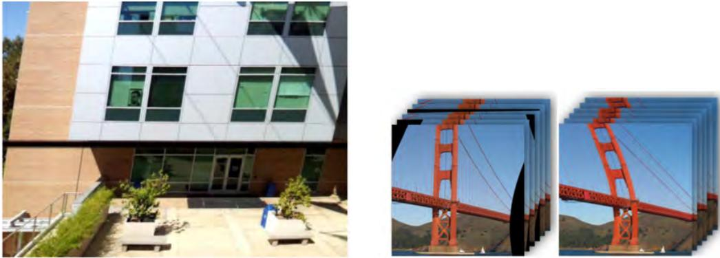
FIGURE 3.4 – Images intégrant des distorsions géométriques provoquées par l’obturateur déroulant lors de rapides mouvements relatifs entre la scène et la caméra. Images issues de [Li 2013] (gauche), et [Guo 2014] (droite).
