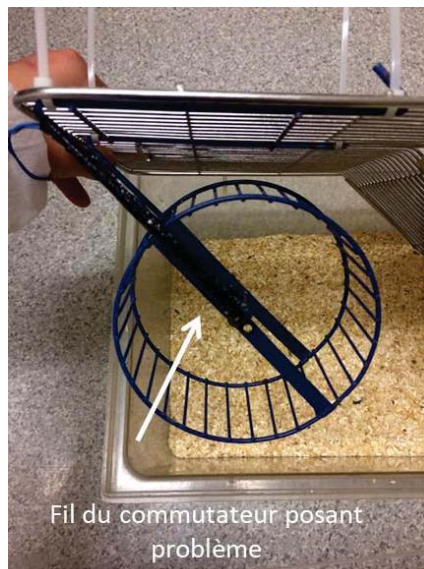
Figure 34 : Montage du système au niveau de la roue d'activité physique spontanée. Le fil du capteur est recouvert de ruban adhésif, ce qui n'empêche pas les souris de le ronger.
