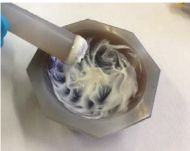
Figure 17 : Photographie d'une expérience de fragmentation d'une huile dans une phase continue aqueuse à l'aide d'un mortier en agate lisse.
