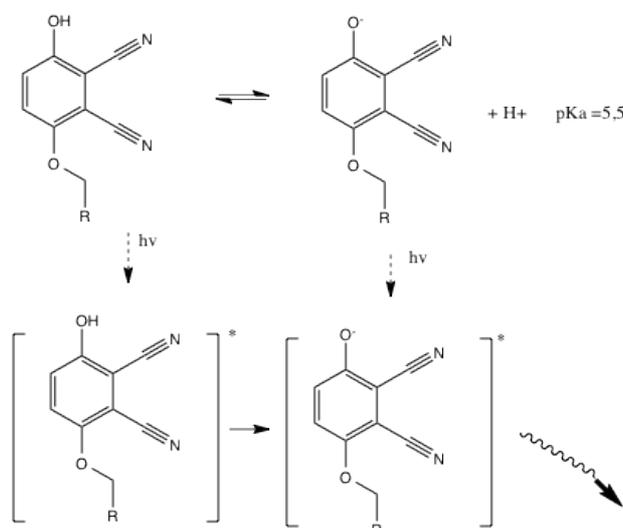
Figure 79 : Principe de fonctionnement des sondes pH.
