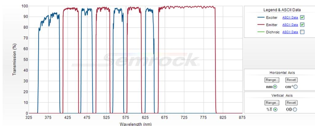
Figure 71 : Caractéristiques spectrales des filtres quadribandes d'excitation (bleu) et d'émission (rouge) utilisés pour la visualisation des gouttes. La lampe est une Lumencor SpectraX à LED. Source : <http://www.semrock.com>
