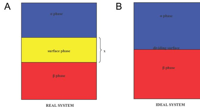
Figure 19 : (A) Schéma représentant la zone interfaciale d'épaisseur finie  $x$  qui existe entre deux phases immiscibles  $\alpha$  et  $\beta$ . (B) Dans le cadre du modèle de Gibbs, la zone interfaciale est considérée sans épaisseur, et sa position est déterminée arbitrairement.
