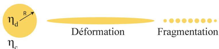
Figure 67 : Représentation schématique du processus de fragmentation par cisaillement d'une grosse goutte d'huile de viscosité  $\eta_d$  dans une phase continue de viscosité  $\eta_c$ . Après élongation, la goutte initiale se fragmente en des objets plus petits Source : [135].
