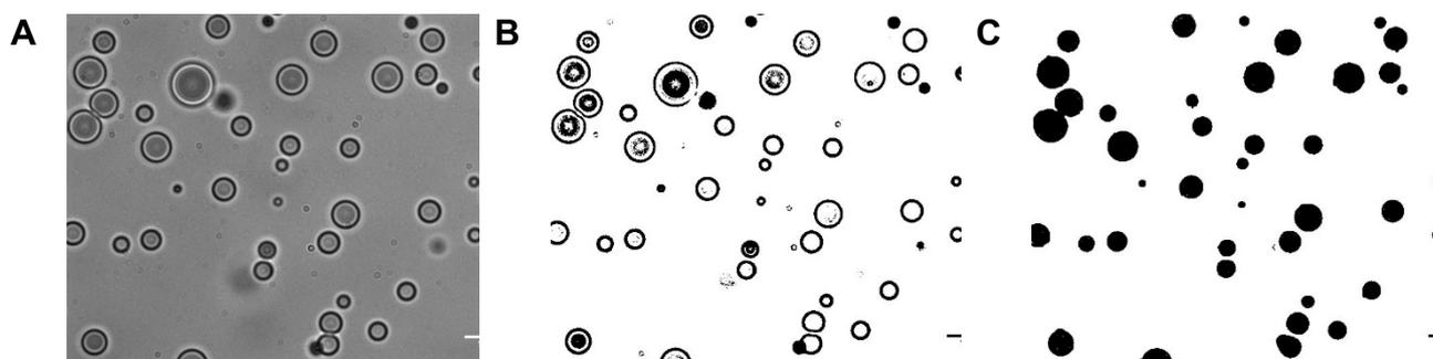
Figure 69 : Image en microscopie en transmission de gouttes d'émulsions (A) qui a été modifiée avec le logiciel Image J. Les gouttes étant très contrastées il est aisé de les seuiller (B) et de les binariser (C) avant de mesurer leur distribution de taille.
