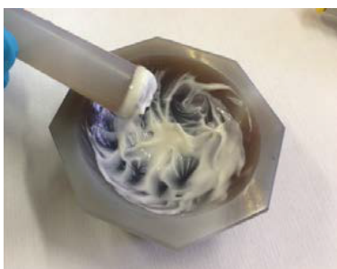
Figure 17 : Photographie d'une expérience de fragmentation d'une huile dans une phase continue aqueuse à l'aide d'un mortier en agate lisse.
