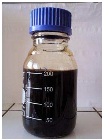
Figure II.1.15 : Suspension de magnétite obtenue après synthèse et optimisation
