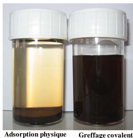
Figure II.2.31 : Photographie dans une solution de NaCl à 0,15M et à pH = 7,4 de magnétite ayant adsorbée du mPEG 2000 ou étant greffée par mPEG 2000 -Si.
