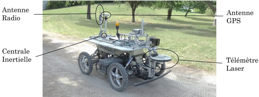
FIGURE A.2 – Position des capteurs sur le robot mobile RobuFAST.
