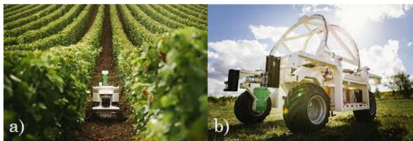
FIGURE 1.12 – Exemple de plateformes robotiques dédiées de l'entreprise Naïo Technologies : a) le robot à chenilles BOB b) le robot enjambeur à deux trains directeurs TED.
