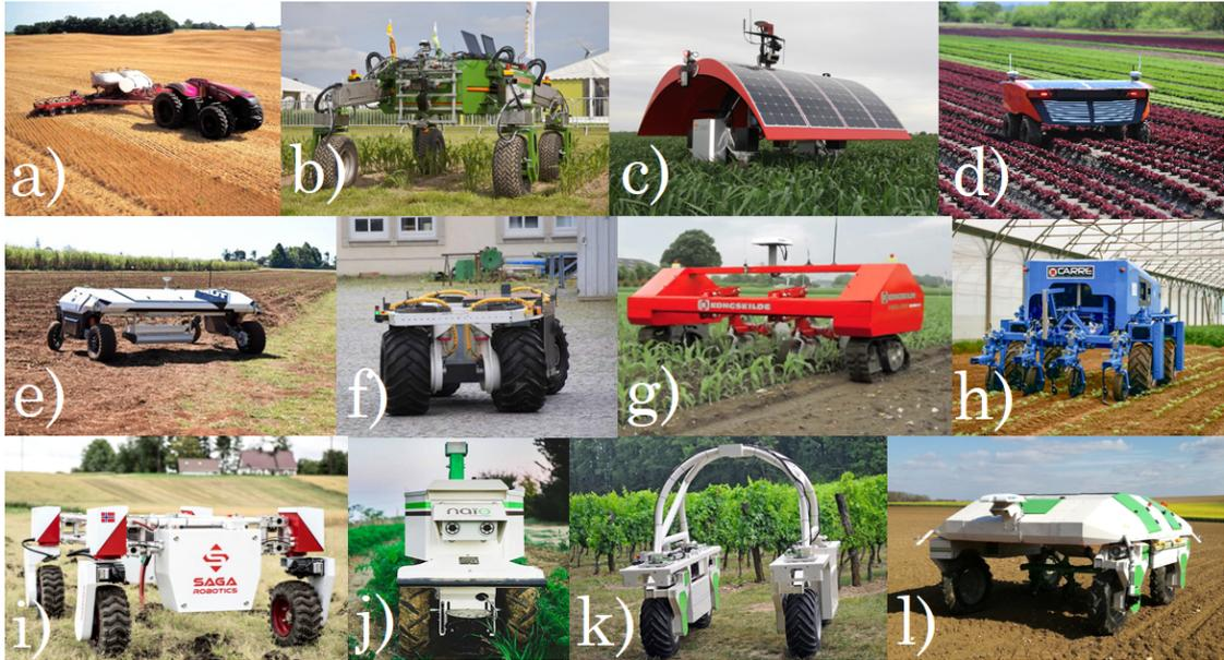
FIGURE 3.1 – Exemples de robots mobiles agricoles. a) Case IH Magnum; b) BoniRob; c) Ladybird; d) Rippa; e) AgBot II; f) El-robot; g) Vibro Crop Robotti; h) Anatis; i) Thorvald; j) Oz; k) Ted et l) Dino.
