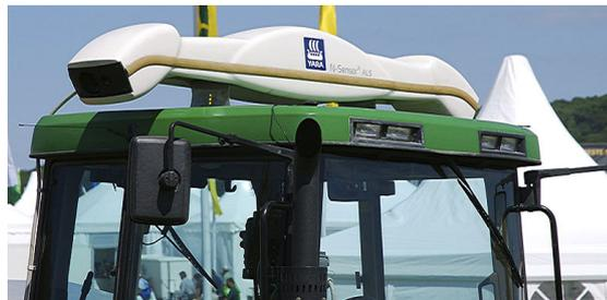
FIGURE 1.9 – Détecteur du besoin en engrais des cultures (Yara). Relié à un ordinateur, il permet de réguler la dose d’engrais pulvérisée [LINK et REUSCH, 2006].
