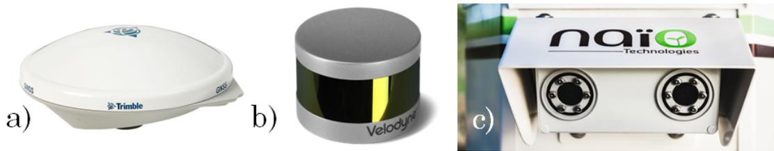
FIGURE 4.1 – Dispositifs de détection extrinsèques. a) Antenne GPS Trimble; b) Télémètre laser Vélocity; c) Dispositif stéréo du robot Oz.
