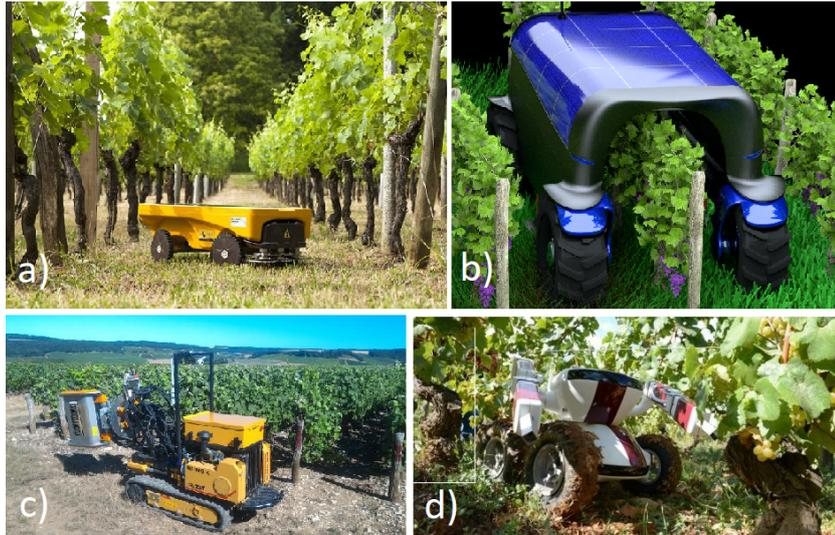
FIGURE 1.14 – Exemple de plateformes robotiques dédiées au milieu viticole : a) Le robot désherbeur VitiRover b) Le prototype d'enjambeur Bakus c) Le prototype de chenillard Hector d) Le robot de taille Wall Ye.
