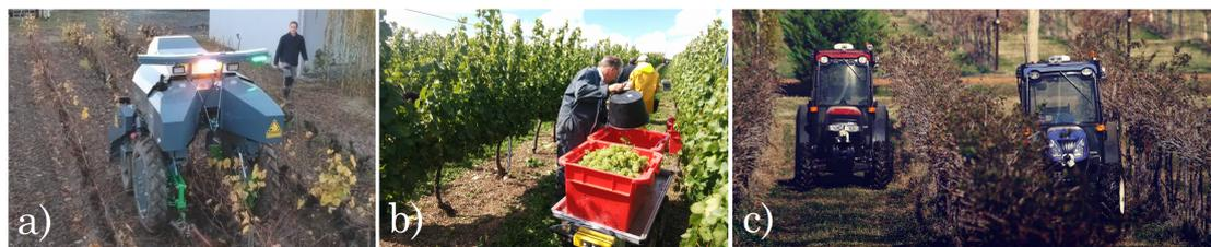
FIGURE 4.2 – Tâches viticoles robotisées : a) désherbage mécanique nécessitant de suivre une rangée, b) coopération homme/robot lors des vendanges nécessitant de suivre une personne et c) monitoring d'une parcelle à l'aide d'un convoi.
