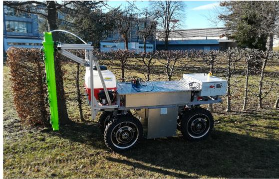
FIGURE 1.15 – Porteur robotique autonome Adap2E.
