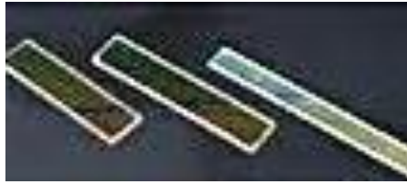
Figure 105 : Cristaux à alternance de polarisation. Les technologies actuelles permettent d'obtenir des cristaux à rapport de forme élevé (typiquement quelques mm de large, 500µm d'épaisseur et plusieurs centimètres de long)
