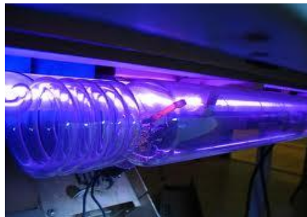
Figure 97 : Tube amplificateur à Argon ionisé (longueur >1 m). Système obsolète pompé par décharges électriques et nécessitant un refroidissement par eau.
