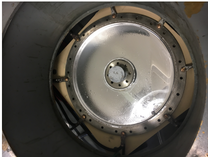
(a) Photo du disque placé entre les deux bobines. Le couvercle de polycarbonate a été retiré. Le galinstan est donc visible en surface libre entre la cathode et l'anode.
