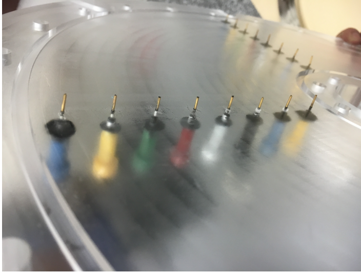
FIGURE 5.4 – Photographie des broches Vives. Chacune d’elles dépasse de 10 mm. Elles sont en nickel et ont été dorées pour optimiser le mouillage. L’espacement entre chaque broche est de 10 mm
