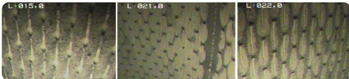
Figure 44 : Extraits de l'inspection vidéo du forage d'injection (bas) du doublet ARHI10 (source : Antea Group France)
