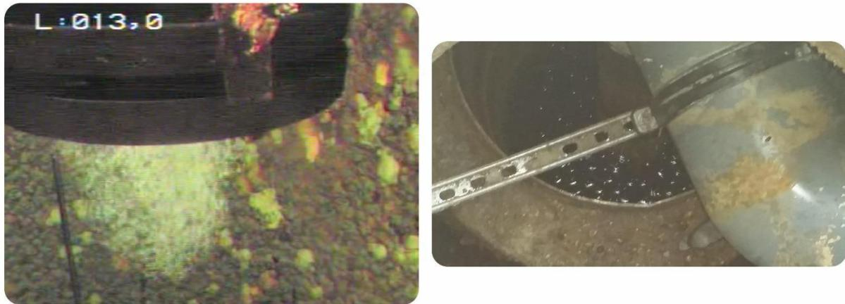
**Figure 71 : Oxygénation de l'eau géothermale en raison d'une boucle primaire non en charge. L'injection de bulles d'air est visible sur les extraits des inspections vidéo (Gauche : Base de la colonne d'injection, Droite : surface de l'eau en tête du forage d'injection) (Burté, 2016)**
