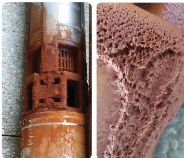
Figure 14 : Pompe d'exhaure recouverte d'hydroxydes amorphes de fer (Burté, 2016)
