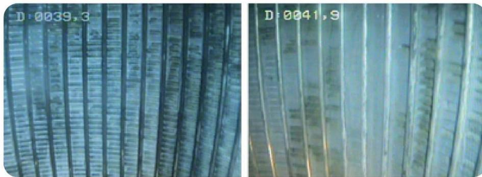
Figure 22 : Observations des crépines colmatées par des particules fines issues du forage de pompage d'un doublet exploitant la nappe des sables de l'Yprésien (source : Antea Group France)
