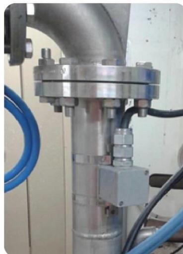
**Figure 10 : Dispositif électromagnétique ST090 (à gauche boîtier de commande, à droite antenne) (Source : Antea Group France)**
