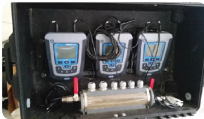
Figure 99 : Exemple de cellule à flux continu destinée à la mesure des paramètres physico-chimiques des eaux de forage
