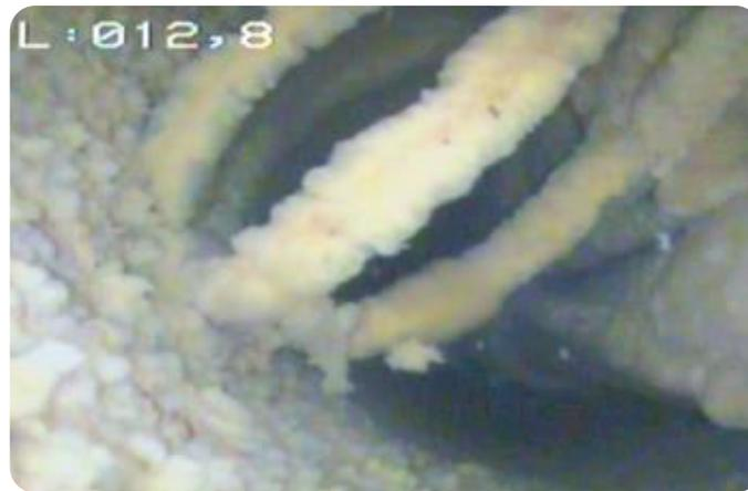
**Figure 4 Exemple d'inspection caméra d'un forage présentant un important développement bactérien sur les parties non productrices (Source : Antea Group France)**
