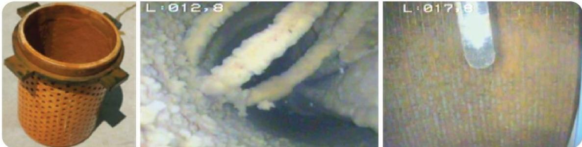
Figure 33 : Photographie du filtre équipant l'installation ARHO6 (gauche), Extrait de l'inspection vidéo du forage de pompage (centre et droite) (source : Antea Group France)
