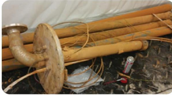
**Figure 4 : Colonne d'injection positionnée dans la zone de rabattement recouverte de dépôts d'hydroxydes de fer (Burté, 2016)**
