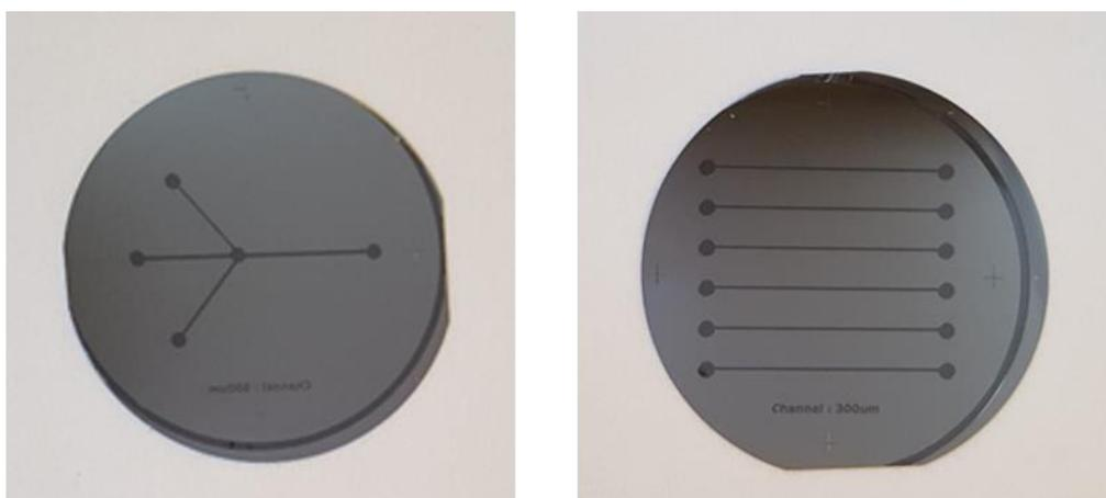
**Figure IV.10.** Photos des moules en résine SU-8 réalisés sur des substrats 2 pouces pour la fabrication des dispositifs microfluidiques. A gauche, modèle patte d'oie : largeur 500  $\mu\text{m}$ , épaisseur 50  $\mu\text{m}$ , longueur 3 cm ; à droite, modèle canaux parallèles : largeur 300  $\mu\text{m}$ , épaisseur 50  $\mu\text{m}$ , longueur 3 cm.
