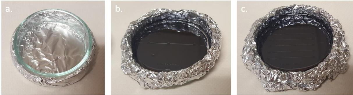
**Figure IV.11.** Photos illustrant deux étapes du procédé de fabrication des capots de PDMS contenant les motifs des canaux microfluidiques. En a, boîte de Petri tapissée d'aluminium pour le coulage du PDMS. En b et c, PDMS coulé sur les moules en résine.
