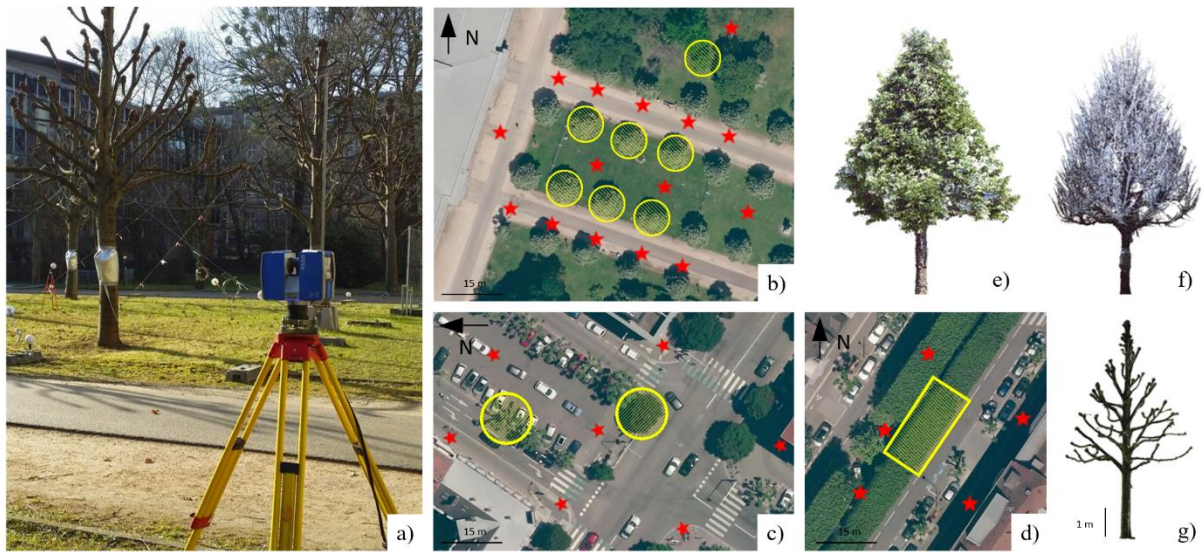
Figure 3.1 – Acquisition de nuages de points d'arbres (cercles jaunes) avec a) un scanner laser terrestre (étoiles rouges représentant les positions du SLT) sur plusieurs zones : b) jardin du Palais Universitaire ; c) boulevard Leblois et d) boulevard de la Marne. Nuages de points obtenus, après pré-traitement, pour le Georges' tree : e) feuillu ; f) non feuillu et g) taillé.
