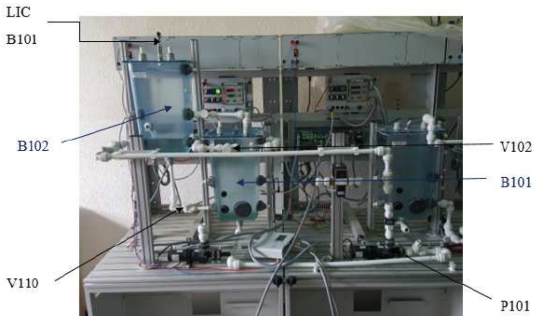
Figure 3.15 – Photo du système de régulation de volume.
