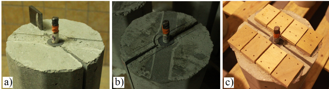
FIGURE 9.4 – Préparation des éprouvettes d'arrachement : a) décoffrage, b) ragréage, c) collage des plaquettes support des LVDT.
