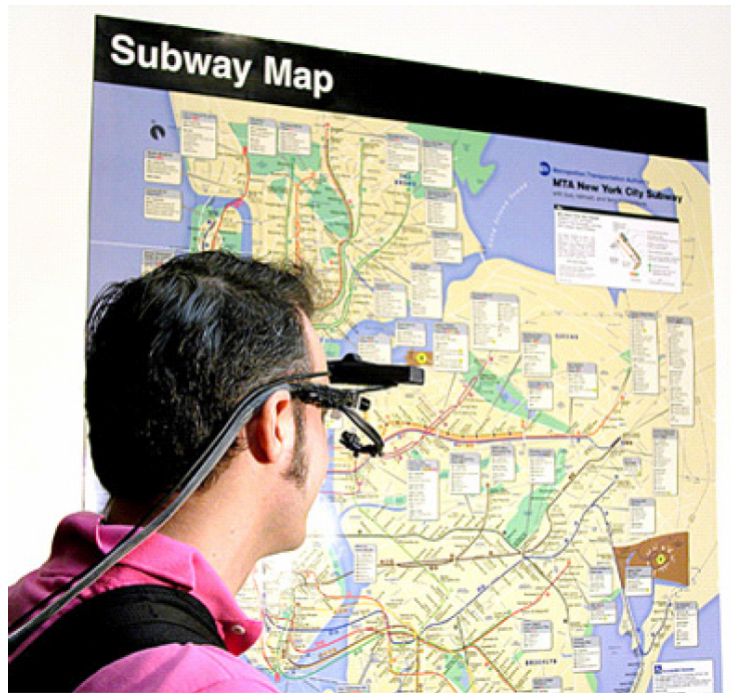
FIGURE 2.7 : EyeGuide assiste l'utilisateur en station de métro pour la recherche de la bonne route.
