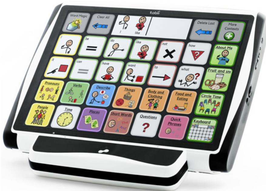
FIGURE 2.3 : Un système d'eye-tracking proposé par Tobii pour les personnes à mobilité réduite.
