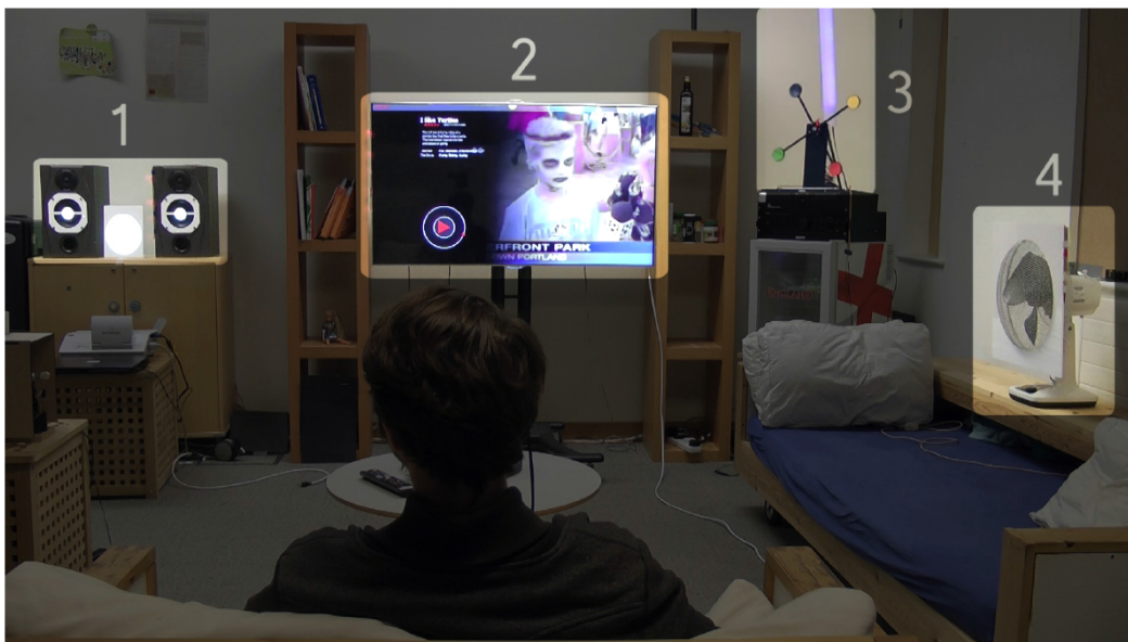
FIGURE 2.19 : Quatre prototypes d'AmbiGaze : (1) lecteur de la musique (virtuel+externe), (2) interface vidéo-sur-demande (virtuel+interne), (3) lampe (mécanique+interne), (4) ventilateur (mécanique+externe).
