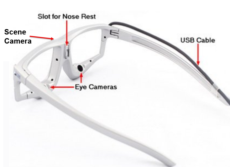
FIGURE 1.4 : L'Eye Tracking Glasses 2 Wireless de SMI. Les deux caméras des yeux filment les mouvements des yeux tandis que la caméra de la scène capture l'image regardée.
