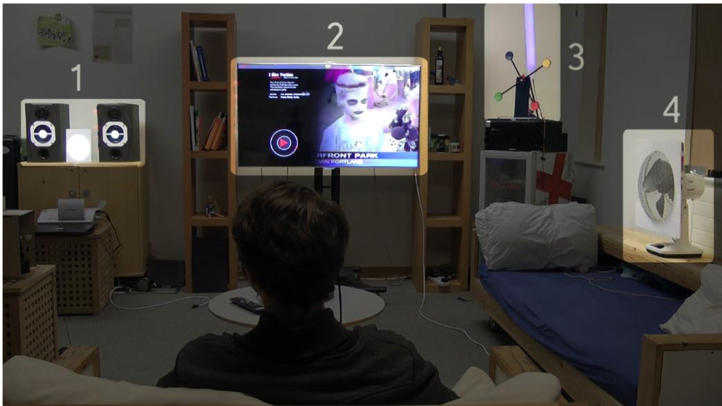
FIGURE 2.19 : Quatre prototypes d'AmbiGaze : (1) lecteur de la musique (virtuel+externe), (2) interface vidéo-sur-demande (virtuel+interne), (3) lampe (mécanique+interne), (4) ventilateur (mécanique+externe).
