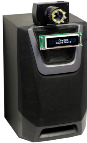
FIGURE 2.5 : EyeTuner composé d'un haut-parleur et d'un ECS digital.
