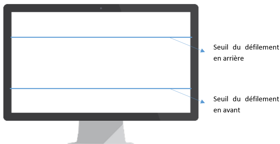
FIGURE 5.1 : Lignes de seuil pour le défilement de la page.
