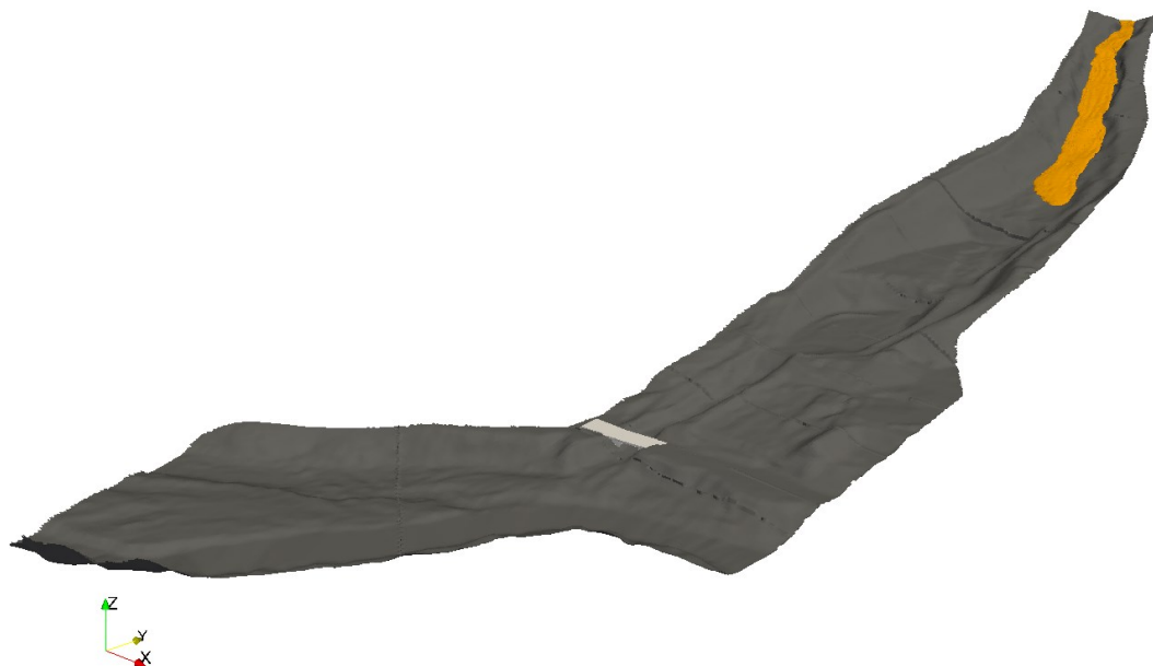
Figure 359 : Représentation de la surface libre de l'écoulement de la lave torrentielle : t = 40\text{ s} .
