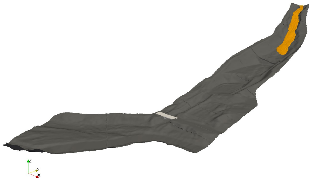
Figure 359 : Représentation de la surface libre de l'écoulement de la lave torrentielle : t = 40 s.
