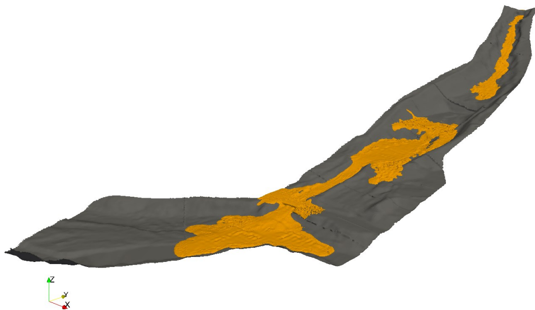
Figure 357 : Représentation de la surface libre de l'écoulement de la lave torrentielle : t = 1\ 000s .
