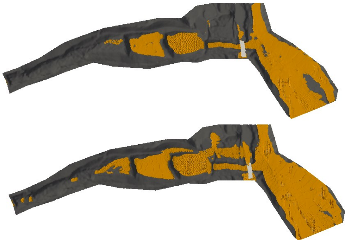
Figure 247 : Sensibilité à la fraction volumique : zones de dépôts finales de lave torrentielles issues du modèle 3D (simulation n°3) pour une contrainte seuil à 4 400 Pa : surfaces libres représentées pour une fraction volumique \alpha égale à 0,5 (en haut) et à 0,1 (en bas).
