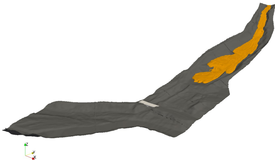
Figure 361 : Représentation de la surface libre de l'écoulement de la lave torrentielle : t = 252 s.
