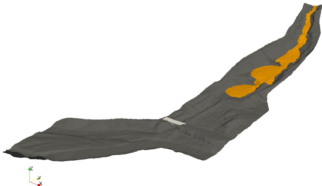
Figure 349 : Représentation de la surface libre de l'écoulement de la lave torrentielle : t = 40\text{ s} .
