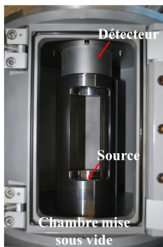
FIGURE 2.5 – Chambre de mesure d'activité par spectrométrie \alpha avec la méthode d'angle solide défini.
