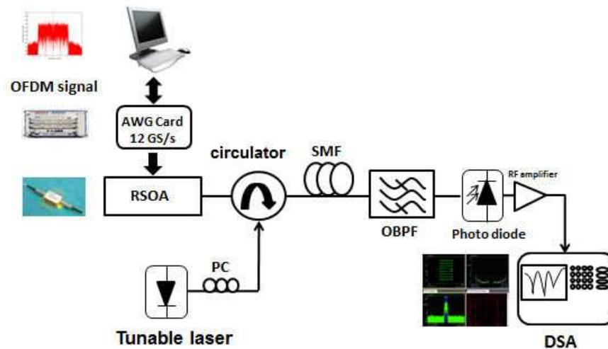
Figure R- 8 : Schéma du dispositif expérimental utilisé.
