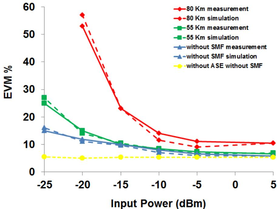
Figure R- 9 : EVM en fonction de la puissance d'entrée pour le signal 16 QAM - OOFDM pour différentes longueurs de fibre SMF. La largeur de la bande passante de signal est de 500 MHz, le RSOA est polarisé à 65 mA, le signal OOFDM est à 1570 nm, et le courant OFDM est de 7 mA.
