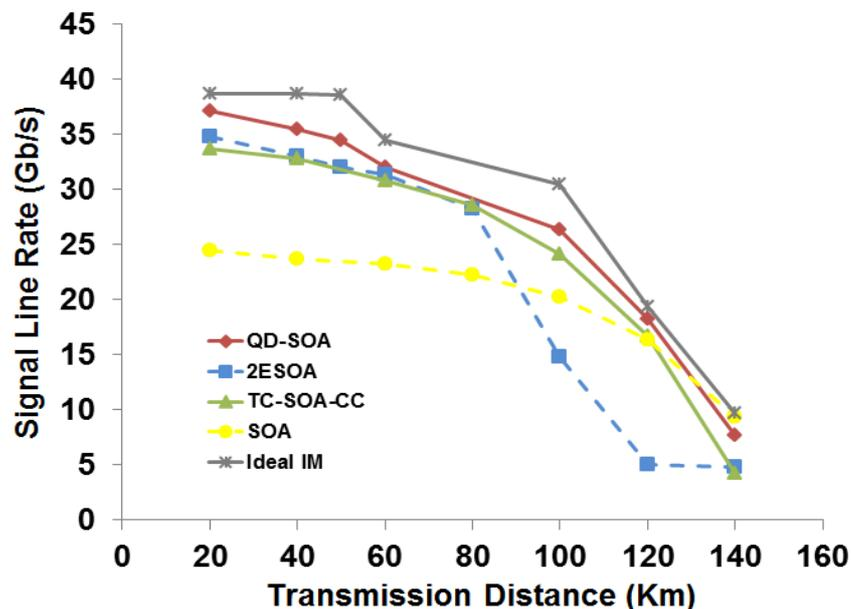
Figure R- 14 : Capacité de transmission en fonction de la distance parcourue pour les structures SOA étudiées.
