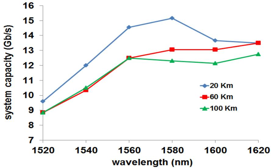
Figure R- 10 : Capacité de transmission en fonction de la longueur d'onde pour un signal de type AMOOFDM et pour différentes distances de transmission.
