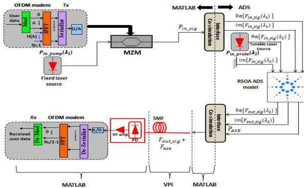
Figure R- 12 : Plate-forme de co-simulation implémentée pour la conversion de longueur d'onde de signaux OOFDM utilisant le RSOA.
