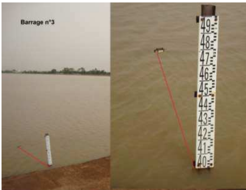
Figure 1. 3 : Photo de l'échelle de mesure de la hauteur d'eau au barrage N° 3
