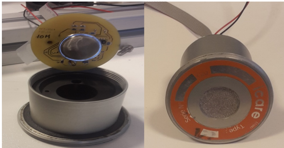
FIGURE 4.7 – Intégration du capteur dans la cartouche du détecteur
