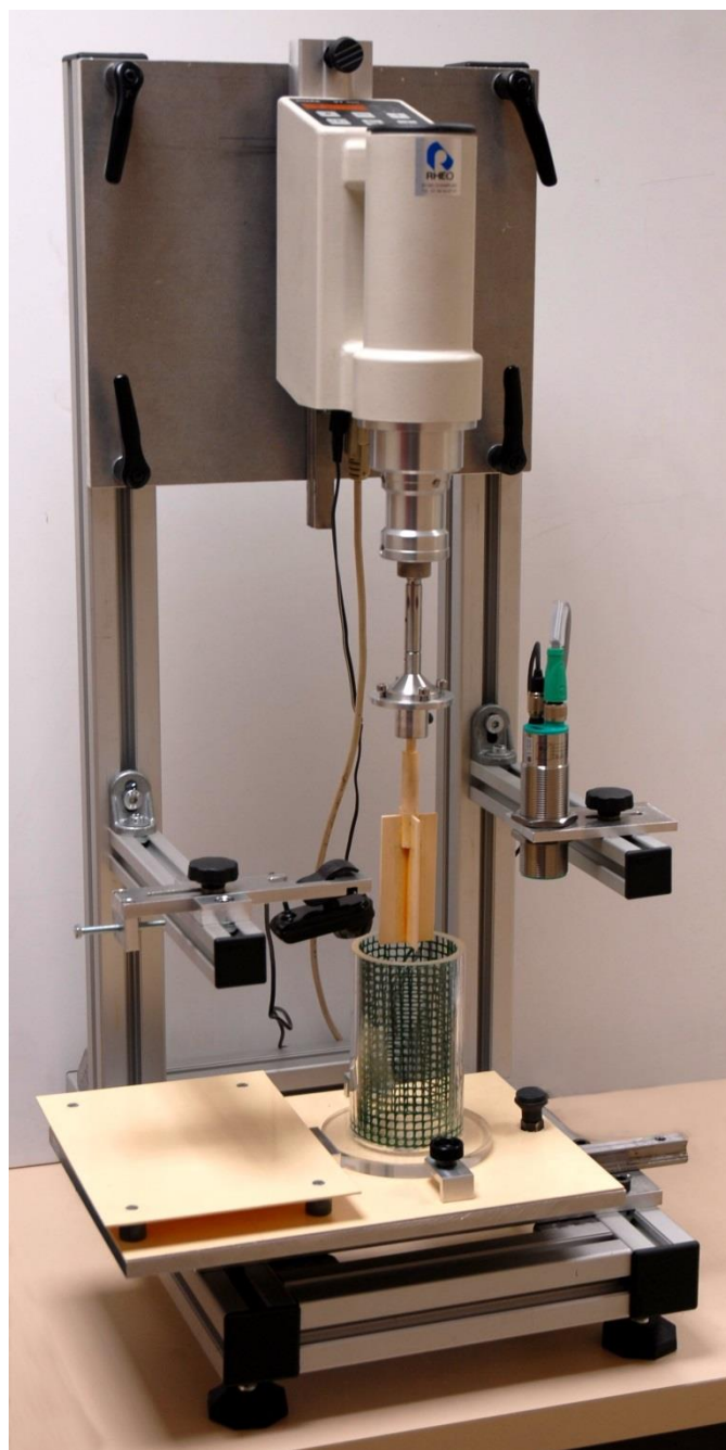
Fig.1 : Dispositif de rhéométrie construit.
