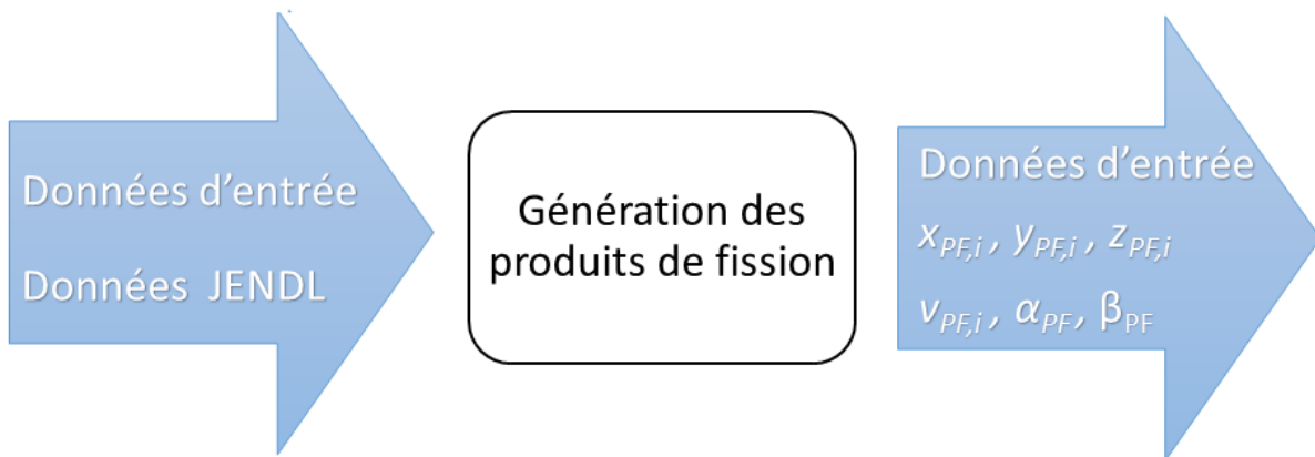
FIGURE 38 – Entrée et sortie du modèle de génération des Produits de fission. Avec JENDL le "Japanese Evaluated Nuclear Data Library", v_{PF,i} la vitesse initiale du produit de fission, et \alpha et \beta les angles de déplacement du produit de fission.
