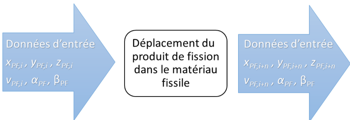
FIGURE 41 – Entrée et sortie du modèle des déplacements de produits de fission dans la couche de matière fissile.
