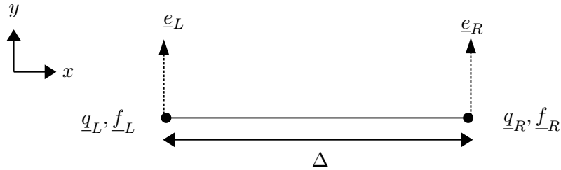
FIGURE 2.2 – Modèle éléments finis d'un élément du guide d'onde et repère local associé
