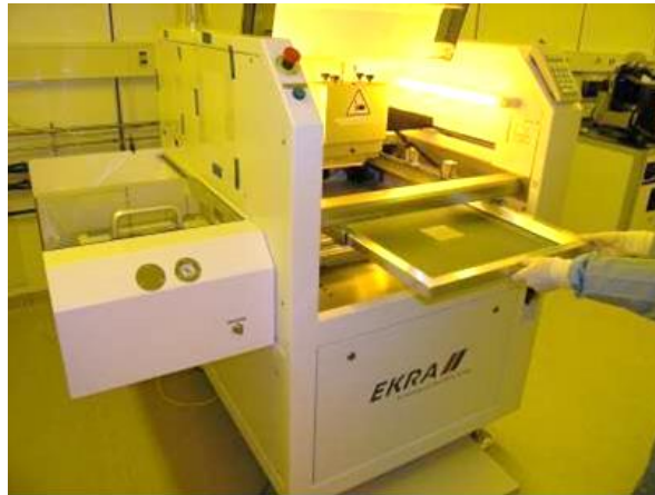
Figure 2-9 : Photo de la machine de sérigraphie EKRA – X5STS utilisée au cours de cette thèse.
