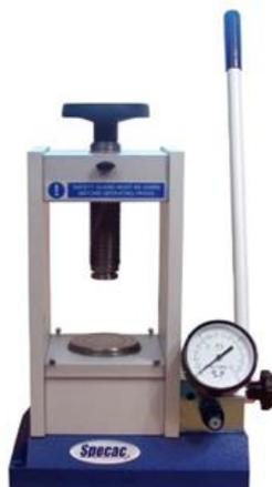
Image 2 - Presse hydraulique utilisée pour compacter les précurseurs
