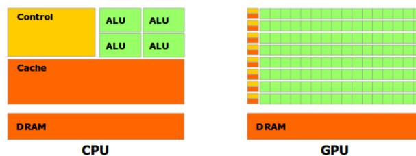
FIGURE 3.8 – Architecture schématique des CPUs et des GPUss issue de [51]
