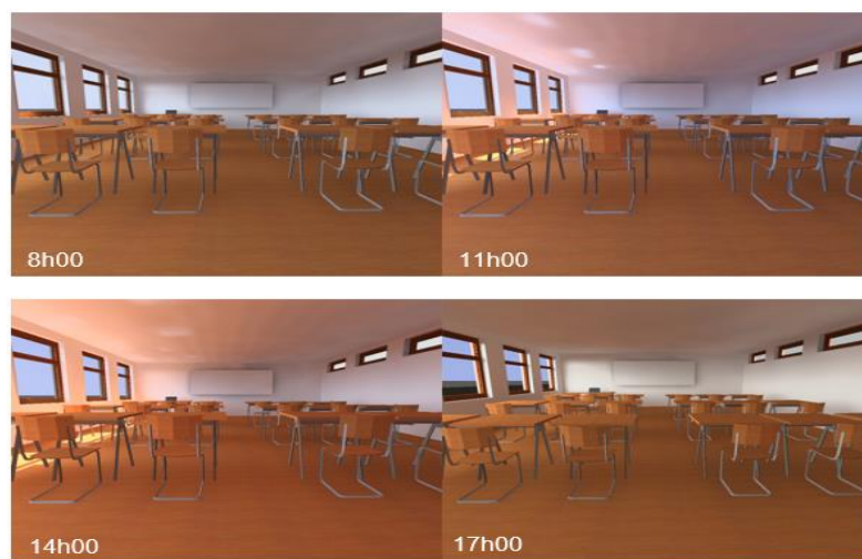
Figure III-23 : Répartition de la lumière du jour dans l'EF SC4
