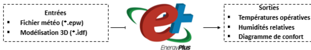
Figure III-12 : Principe de l'analyse thermique
