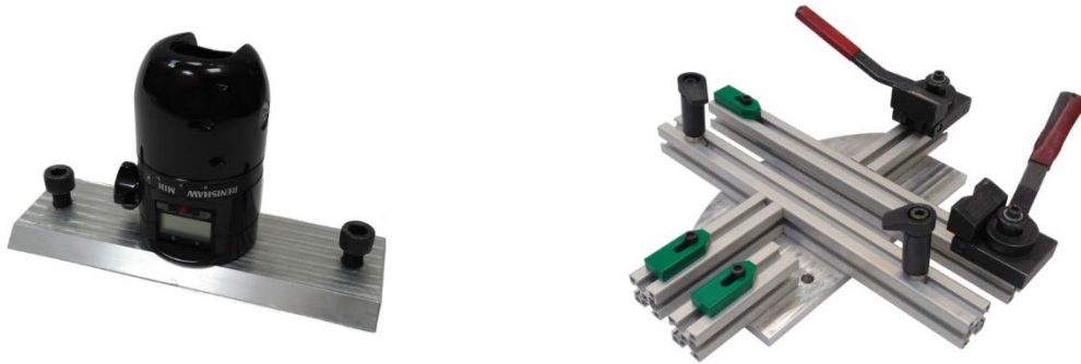
Figure 3 : Interfaces robot/Zephyr (à gauche) et robot/Pièce (à droite)
