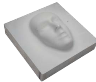
Figure 89 : Visage usiné servant de pièce test
