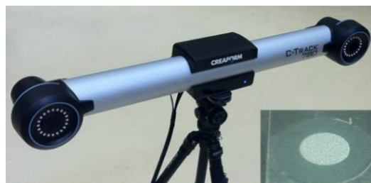
Figure 5 : C-Track et cible réfléchissante
